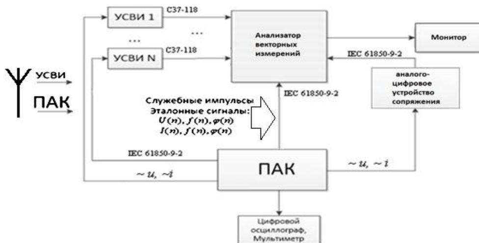
Рисунок Г.1. Тестовая схема для проведения сертификационных испытаний УСВИ
