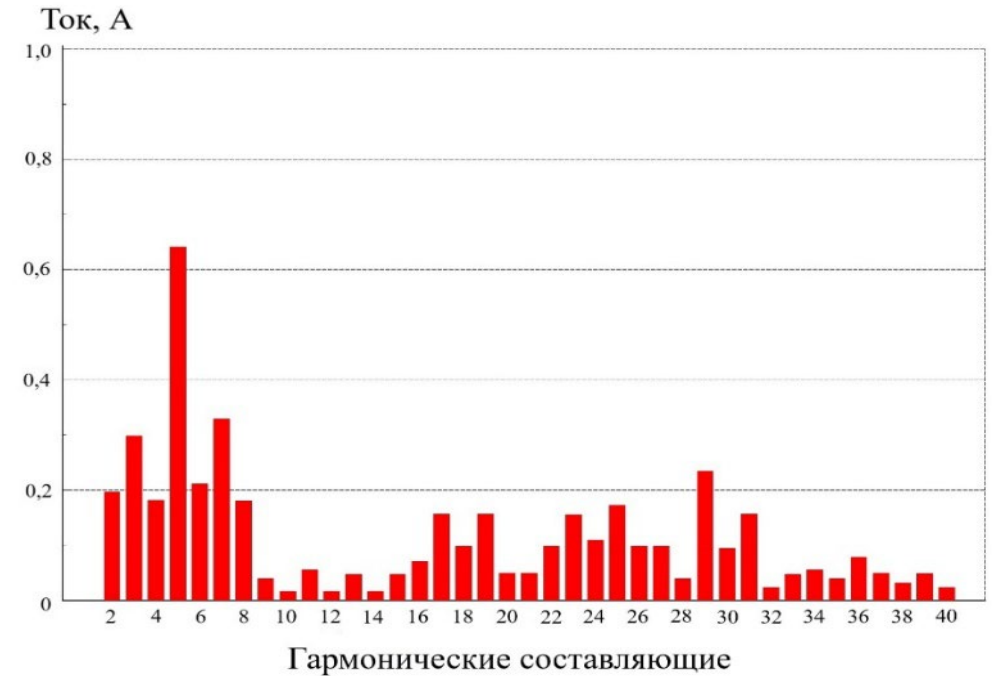
Рис. 2. Результаты измерений гармонических составляющих в токе ВЭУ на стороне 35 кВ повышающего трансформатора 0,69/35 кВ
