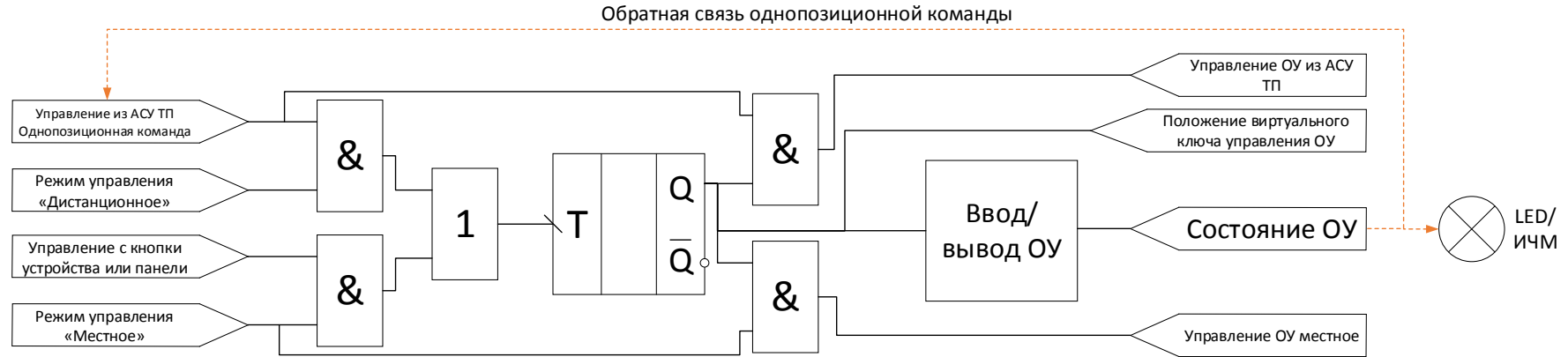
Рисунок Ж.4. Реализация программируемой логики управления функцией при использовании кнопок для управления функцией
