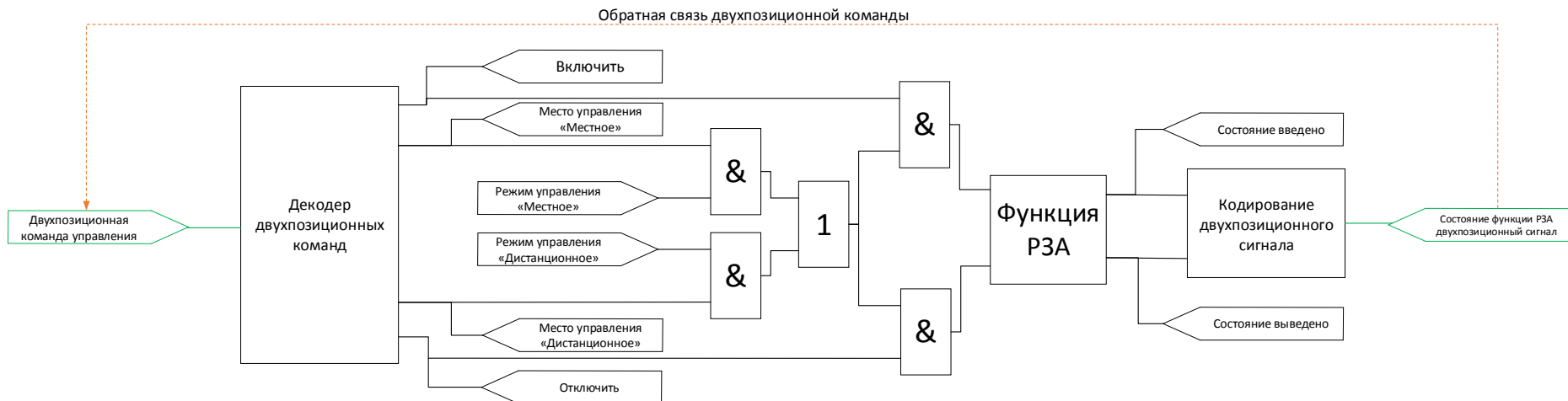
Рисунок Г.2. С использованием двухпозиционных команд
